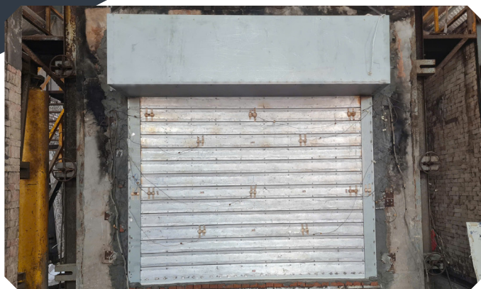
CỬA CUỐN NGẮN CHÁY GIỚI HẠN CHỊU LỬA EI60 FSD-60
